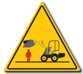
Erlauben Sie niemals, dass sie eine Person unter einem angehobenen Hubarm befindet
